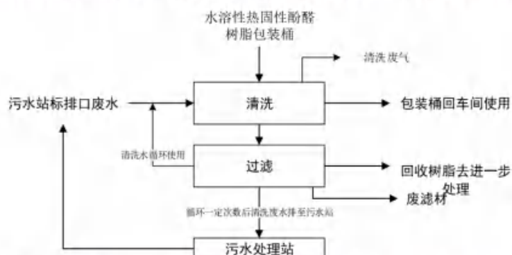
图 2.2-3 水溶性热固酚醛树脂包装桶清洗生产工艺及产污节点图
